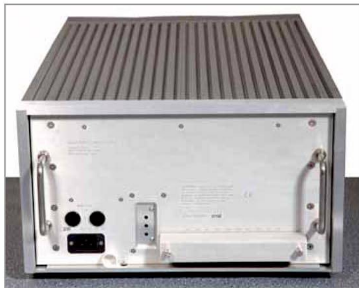
Il pannello posteriore dell'alimentazione con, sulla destra le connessioni per il finale [in questo caso coperte da un'apposita protezione in lamiera].
