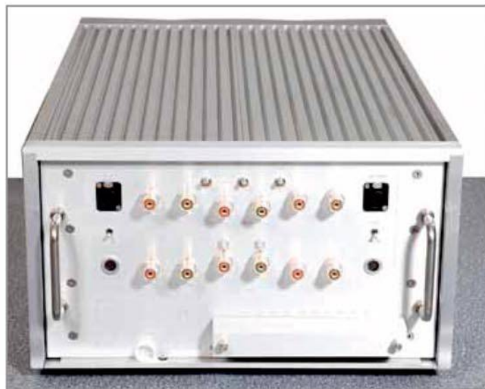
Il retro del finale vero e proprio con le connessioni per i diffusori sdoppiati per varie impedenze, i selettori delle impedenze medesime e gli ingressi XLR.
