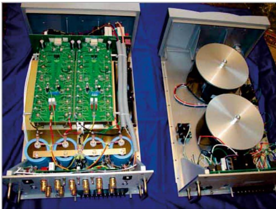
Vista di insieme dei due telai che compongono il Viola Bravo: sulla sinistra l'unità di amplificazione vera e propria, mentre sulla destra l'alimentatore.
