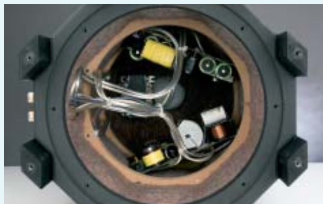
Il diffusore visto da sotto una volta rimosso il woofer. Si nota il rivestimento interno in feltro, i due supporti del filtro crossover, la grossa induttanza avvolta su nuclei di lamierini e l'apertura per il risonatore interno.
