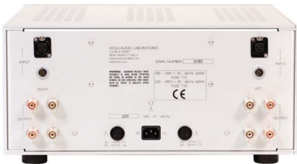
La struttura dual mono dell'ampli Symphony è evidente anche nel pannello posteriore dove, oltre agli ingressi XLR sono inserite le doppie morsettiere per i diffusori.
