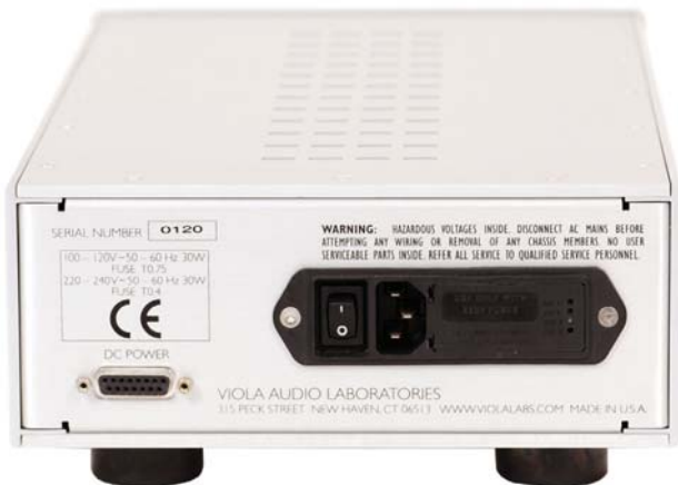
Sul retro dell'alimentatore c'è solo la vaschetta IEC, l'interruttore e, in basso a sinistra, il curioso connettore per portare la tensione di rete al preamplificatore.
