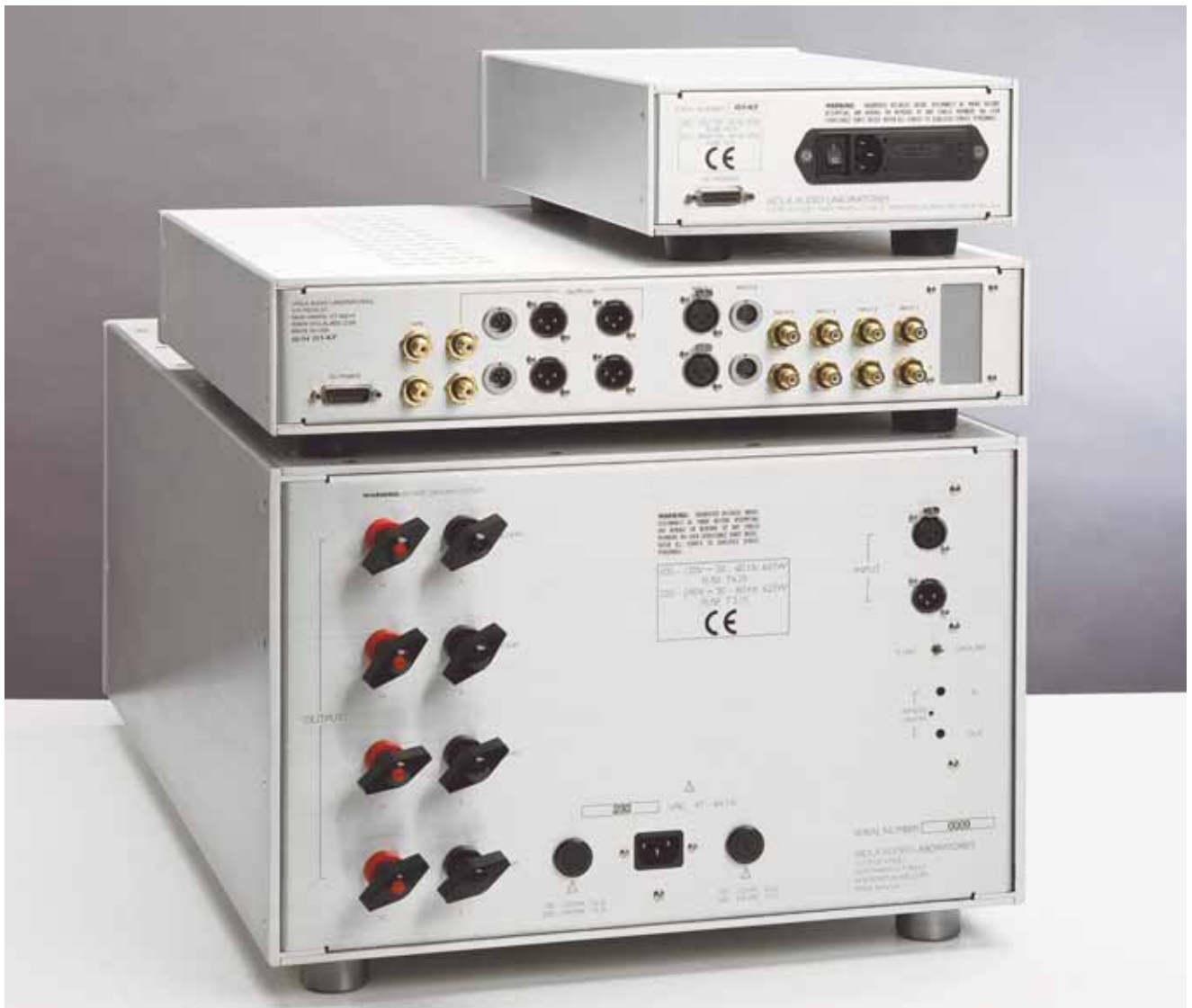
Il collegamento tra la sezione di alimentazione e di preamplificazione utilizza dei robusti connettori multipolari ed il blocchetto che contiene la vaschetta IEC integra anche i fusibili e il regolatore per la tensione di alimentazione. La dotazione di ingressi del preamplificatore prevede quattro single-ended e due bilanciati, ma in realtà ce n'è anche un quinto che però è attualmente inutilizzato, essendo predisposto per l'installazione di un eventuale modulo aggiuntivo. Ovviamente anche le uscite sono nei due formati ed è presente un'uscita sbilanciata per il registratore. L'ingresso della sezione finale del Legacy impiega esclusivamente prese bilanciate: da notare i massicci, ma comodissimi, morsetti per il collegamento dei diffusori e la separazione in funzione delle diverse impedenze accettate dal trasformatore di uscita.
