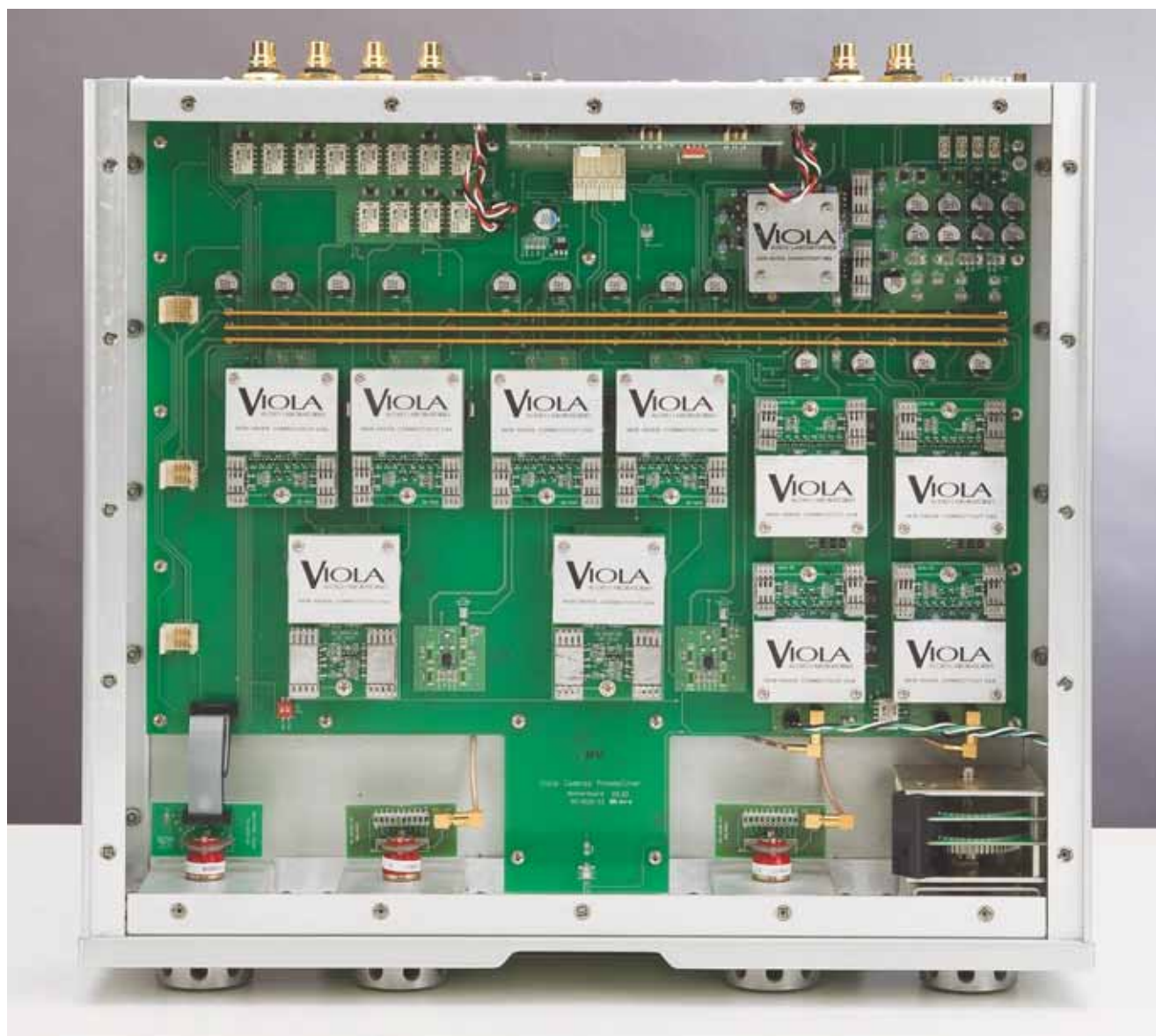
È una realizzazione da manuale quella del preamplificatore, basata su un'unica grande scheda a circuito stampato che occupa praticamente tutta la pianta dell'apparecchio: per garantire la riproducibilità delle prestazioni, il circuito di amplificazione è stato ripartito nei moduli visibili nella foto.
